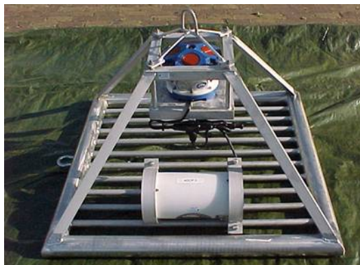
Figuur 3 ADCP geplaatst in meetframe
