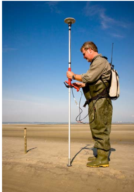
Figuur 2`: RTK meting bij een sedimentatie/erosie punt
